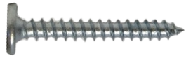
Vis autotaraudeuse type « A » n° 10 x 1 po – métal sur bois – empreinte Quad Drive, tête plate type pancake, fixation dissimulée, zinguée (AFWO0400100002)
